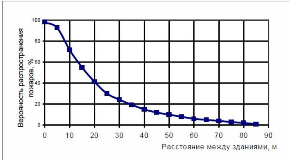
Рис. 9. «График зависимости вероятности распространения пожаров от плотности застройки»
